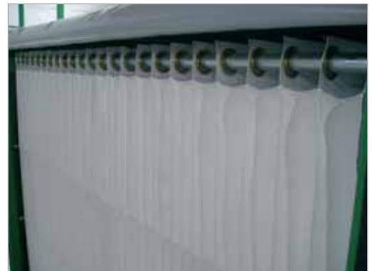
schonende Teileaufnahme durch strapazierfähigen Materialmix und spezielle Taschenöffnungen
